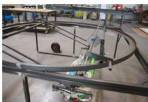
Ce bâti est révolutionnaire de par sa conception : il peut être utilisé avec une machine SUPERCUT de 1200 mm ou de 1600 mm de largeur de coupe ! Il mesure 2 m x 2 m.
